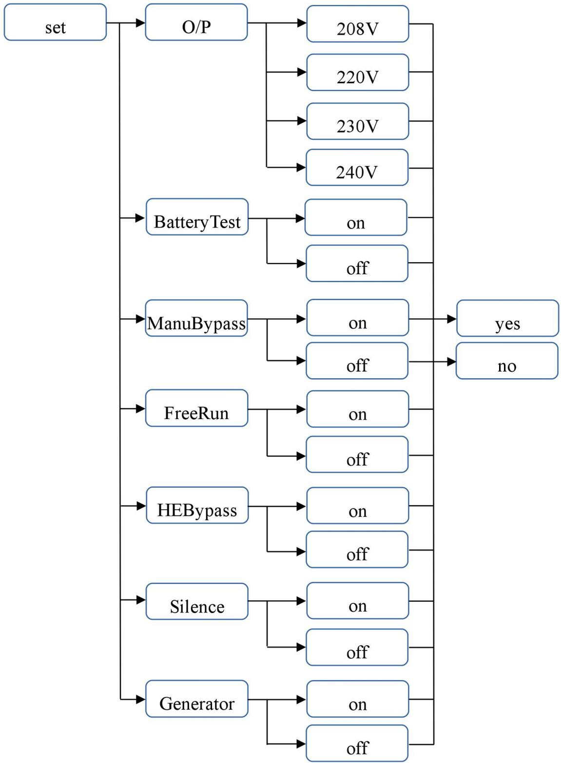
Рис. 9. Настройки ИБП
