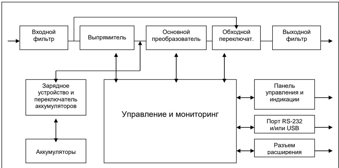
Рис. 1. Блок-схема ИБП
