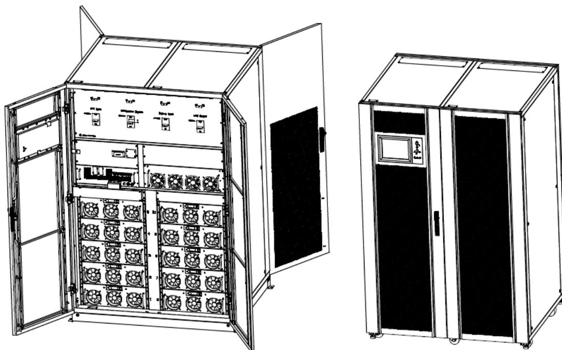
*Рисунок 2-9(в) Структура ИБП для 10 силовых модулей*
