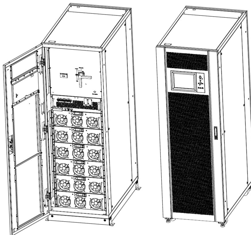
*Рисунок 2-9(в) Структура ИБП для 6 силовых модулей*
