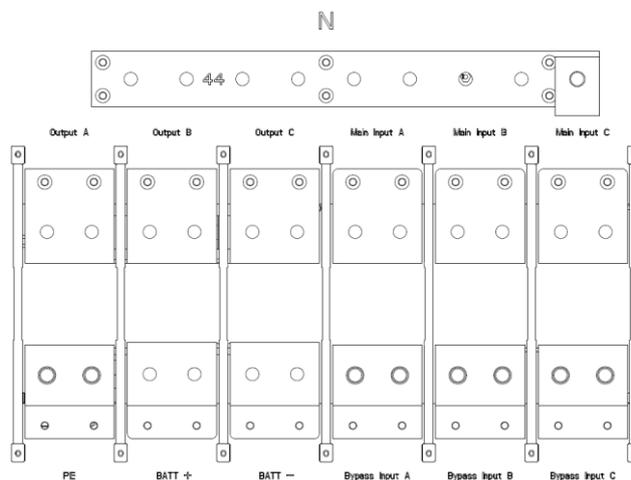
Рисунок 3-12 (в) Клемма 6-ти модульного ИБП
