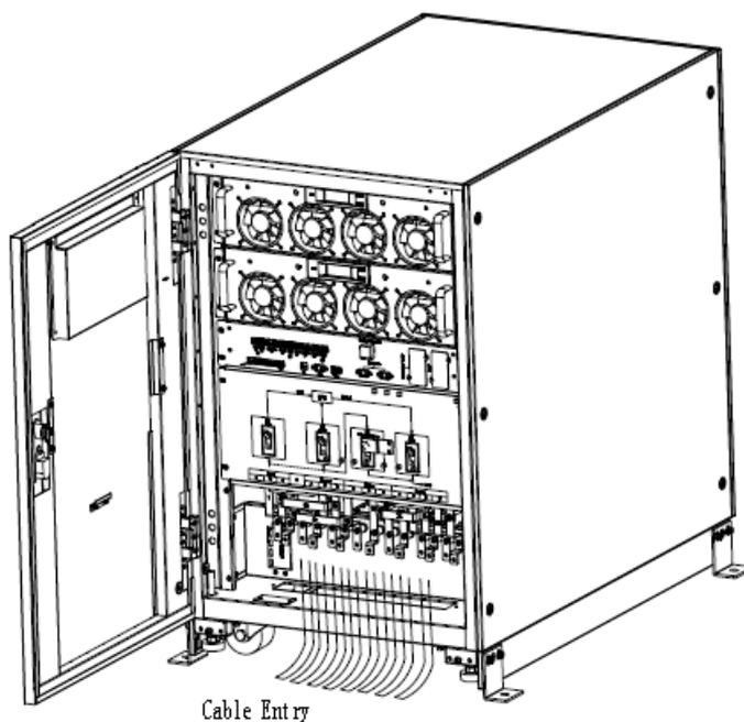
Рисунок 3-11 (а) Подвод кабелей для 2-4-х модульного ИБП
