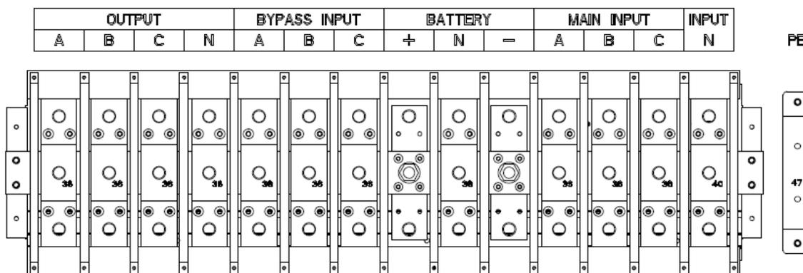
Рисунок 3-12 (г) Клемма 10-ти модульного ИБП
