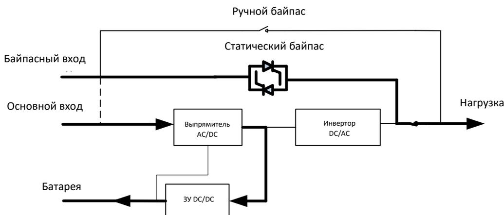
Рисунок 2-8 Структурная схема ИБА в ЭКО-режиме
