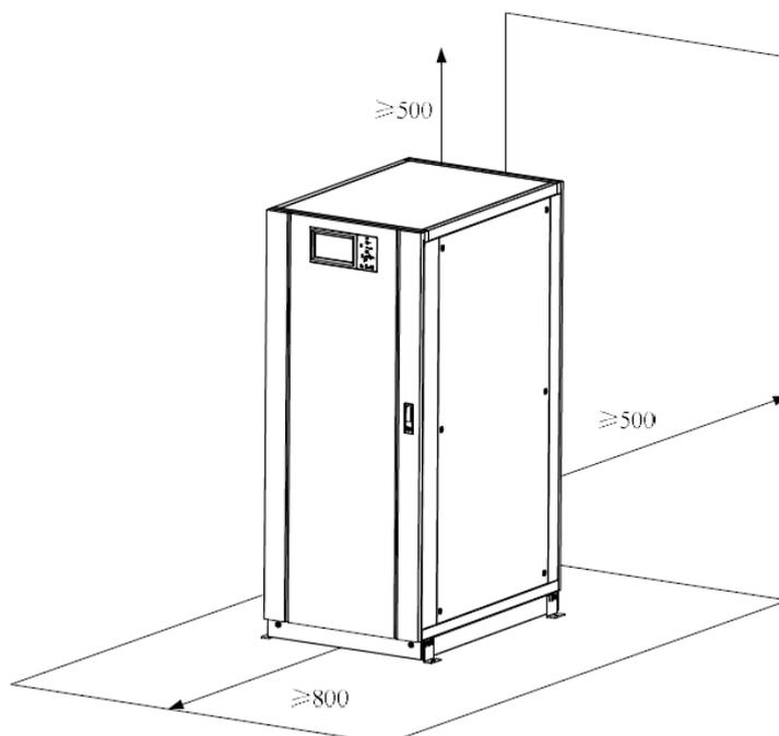
Рисунок 3-1 Размеры помещения для ИБП
