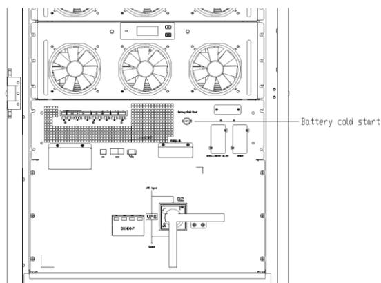
Рисунок 5-2(б) Кнопка холодного запуска для 4-х модульного ИБП
