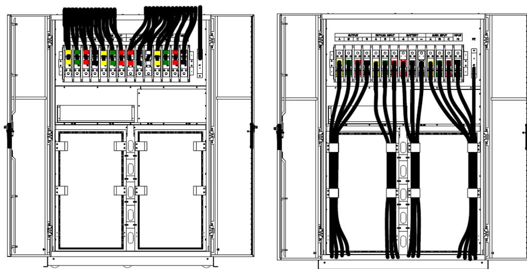
Рисунок 3-11 (в) Подвод кабелей для 10-ти модульного ИБП
