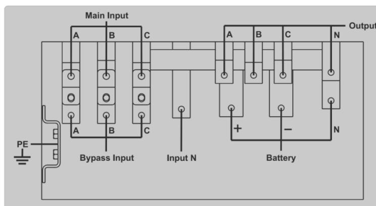
Рисунок 3-12 (б) Клемма 4-х модульного ИБП
