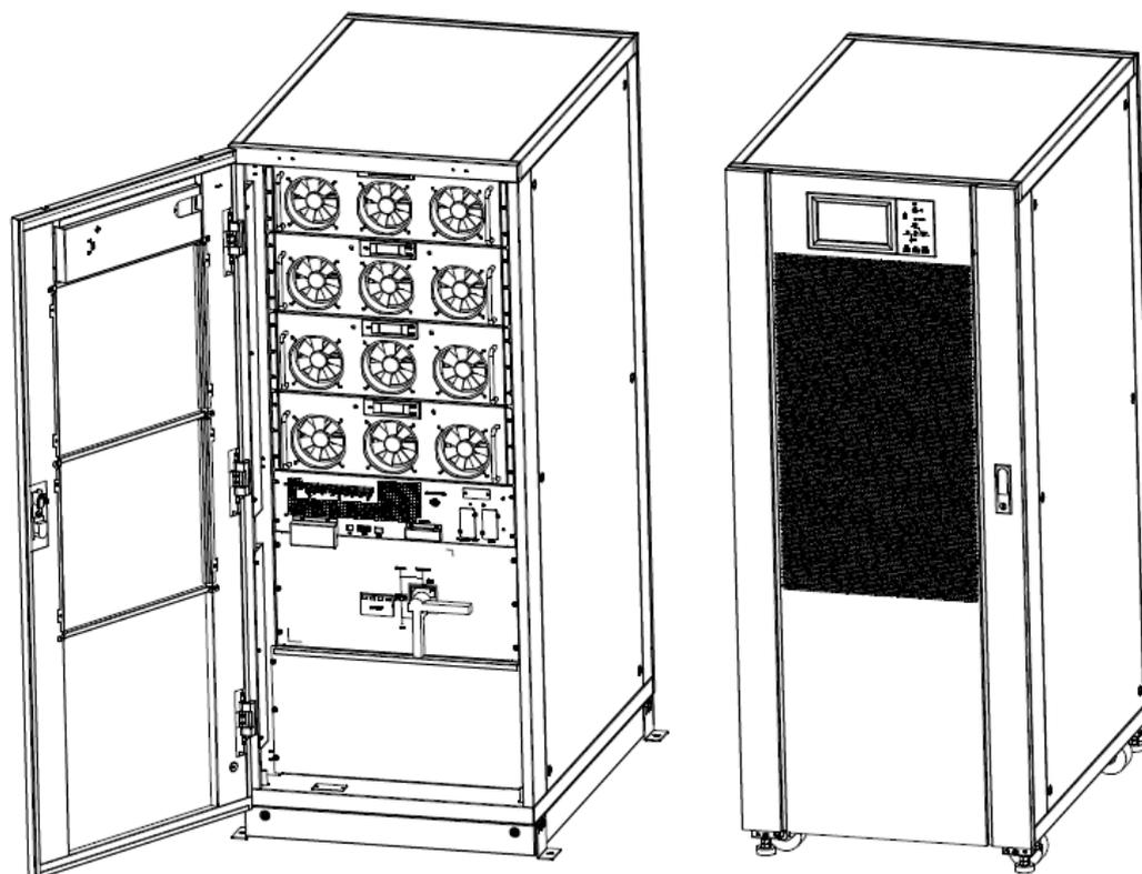
Рисунок 2-9(б) Структура ИБП для 4 силовых модулей
