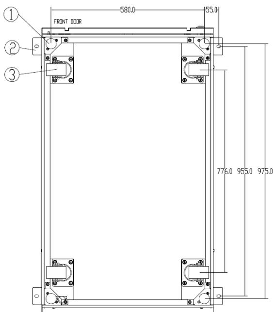
Рисунок 3-8 (в) Несущая конструкция ИБП для 6 силовых модулей
