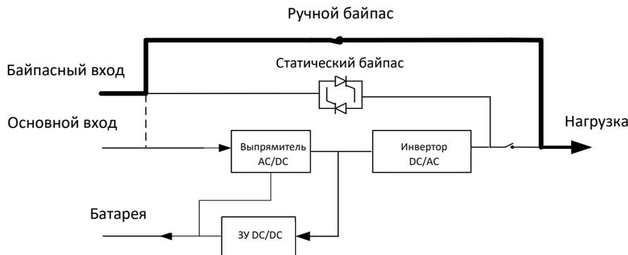
Рисунок 2-7 Структурная схема ИБП в режиме обслуживания
