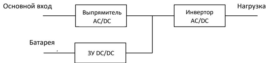
Рисунок 2-2 Структурная схема силового модуля
