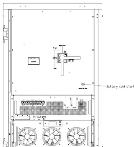
Рисунок 5-2(в) Кнопка холодного запуска для 6-ти модульного ИБП
