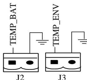
Рисунок 3-17 Порты J2 и J3 для температурного датчика
