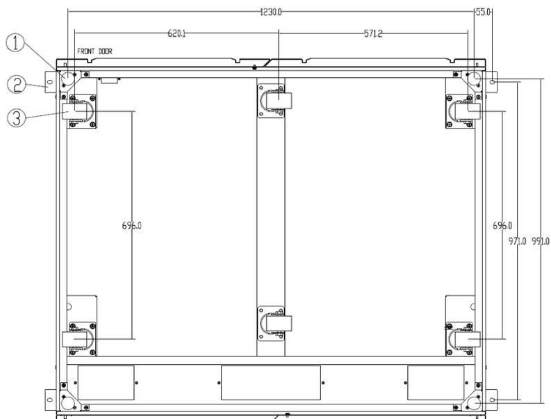
Рисунок 3-8 (г) Несущая конструкция ИБП для 10 силовых модулей
