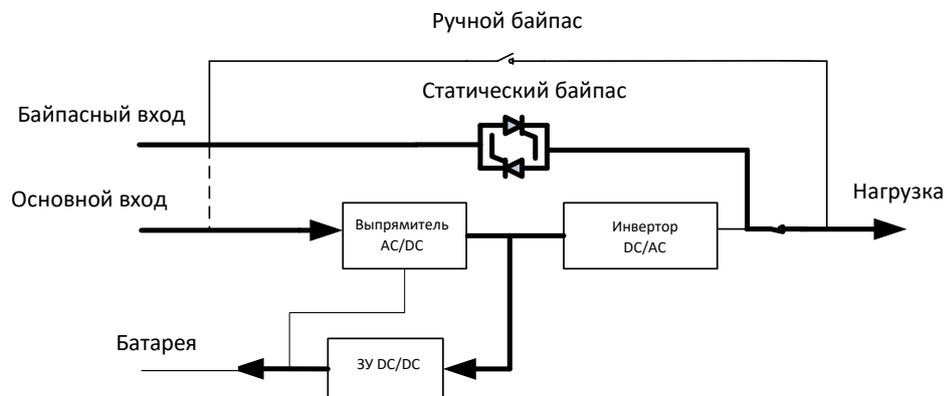
Рисунок 2-6 Структурная схема ИБП в режиме байпаса
