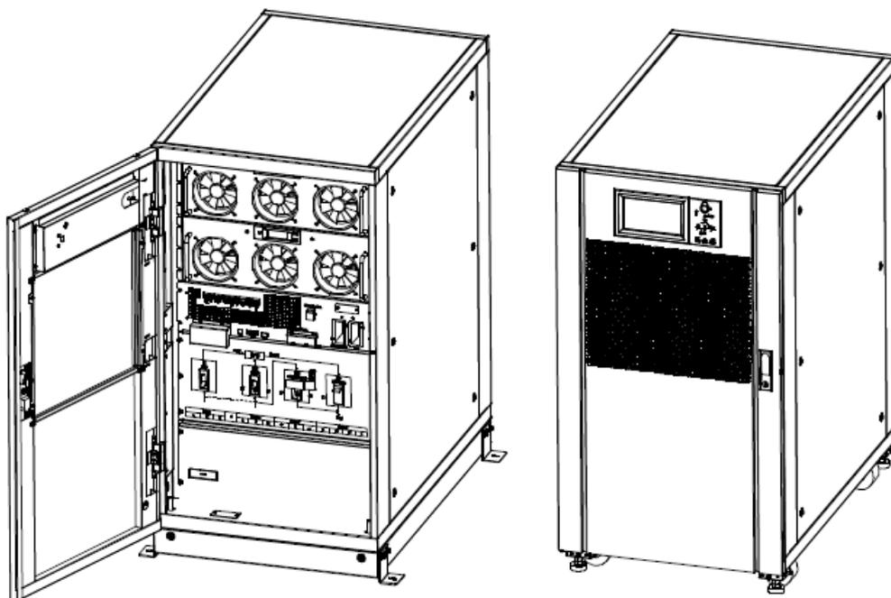
Рисунок 2-9(а) Структура ИБП для 2 силовых модулей
