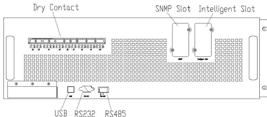
Рисунок 3-16 (б) Расположение интерфейсов для 6-ти модульного ИБП
