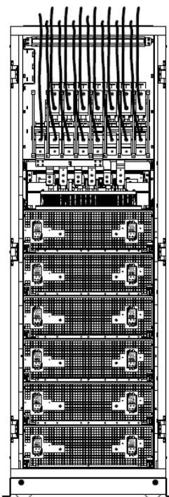
Рисунок 3-11 (б) Подвод кабелей для 6-ти модульного ИБП
