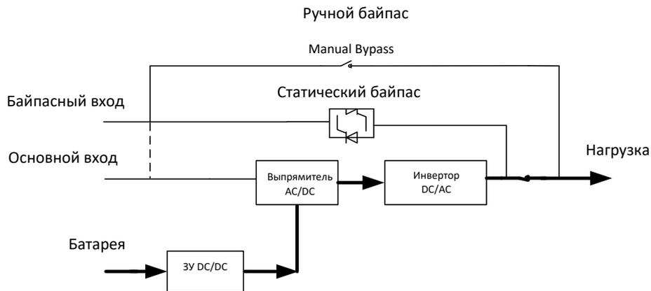
Рисунок 2-4 Структурная схема работы ИБП в режиме от АКБ
