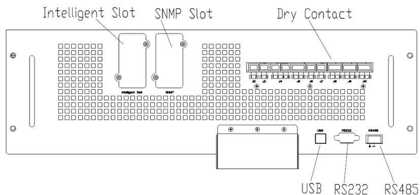
Рисунок 3-16 (б) Расположение интерфейсов для 10-ти модульного ИБП
