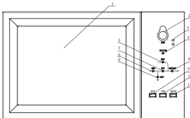
1-Сенсорный ЖК-экран; 2-аварийное отключение (EPO); 3-звуковой сигнал тревоги (зуммер); 4-Индикатор состояния ИБП; 5-Индикатор байпаса; 6-Индикатор выпрямителя; 7-Индикатор инвертора; 8-Индикатор нагрузки; 9-Индикатор батареи; 10-Переключение на байпас; 11-переключение на инвертор; 12-отключение звука
