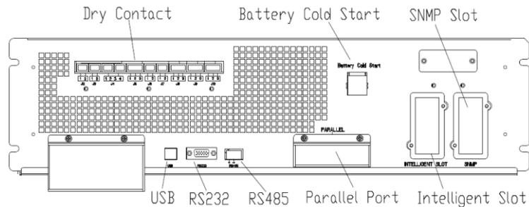
Рисунок 3-13 (а) Расположение интерфейсов 2 и 4 модульного ИБП
