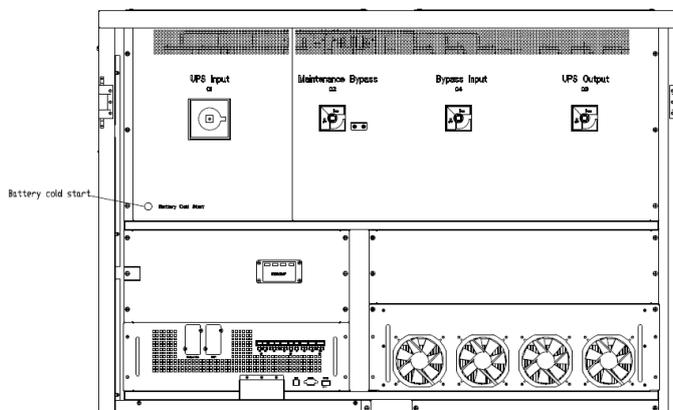
Рисунок 5-2(г) Кнопка холодного запуска для 6-ти модульного ИБП
