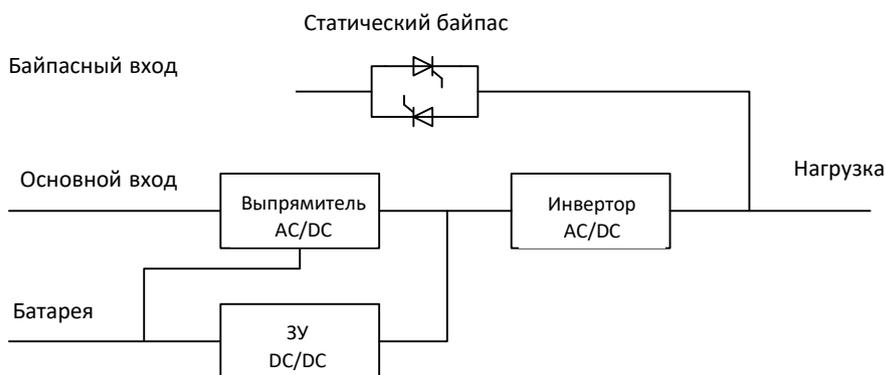
Рисунок 2-1 Структурная схема модульного ИБП
