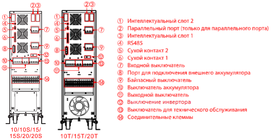
Рис. 2-6 Вид задней панели VGD-II-10-20K33HC
