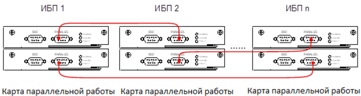
Рис. 3-36 Подключение параллельной системы (с несколькими ИБП)
