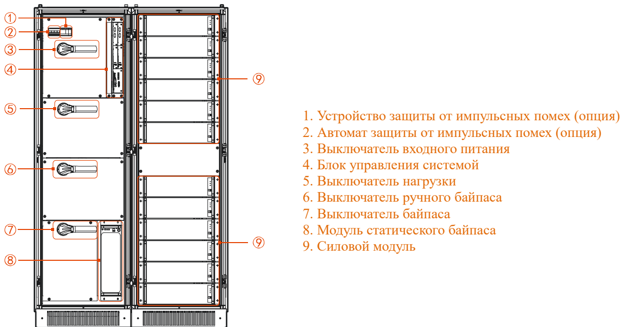
Рис. 2-7 Схема расположения элементов ИБП VGD-II-400M33HP-50, VGD-II-500M33HP-50, VGD-II-600M33HP-50
