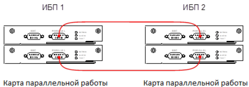
Рис. 3-35 Подключение карты параллельной работы (для 2 ИБП)
