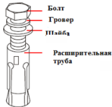
Рис. 3-12 Конструкция и установка анкерного болта
